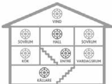
Bild 2. Placering av brandvarnare i flerplansfastighet /villa.
