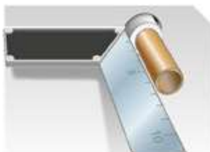
Exempel: Rör vinkelrätt genom vägg med tätskikt.
