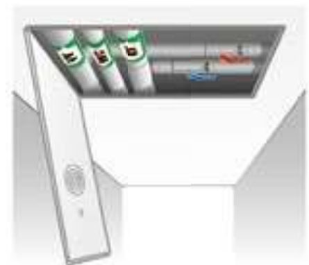
Ovan inklädnad i tak med vattentätt golv.
