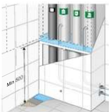
Exempel på placering av tappvattenrör i schakt.
