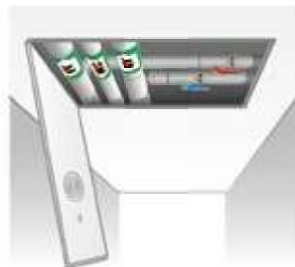
Exempel på serviceöppning: dränerande taklucka.
