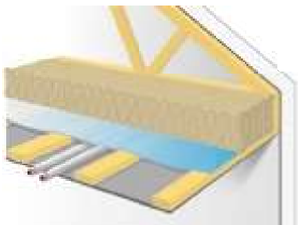
Exempel på rörförläggning på "varma sidan" i vindsbjälklag.
